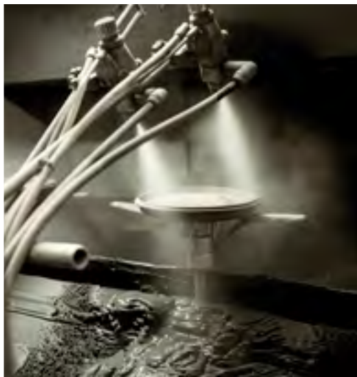
Emaillierung mit 2 bis 3 Schichten, innen und außen
