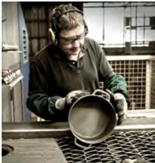
Reinigungsstrahlen zur Entfernung von Formsand
