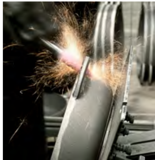
Entfernen von Unebenheiten (Entgraten)
