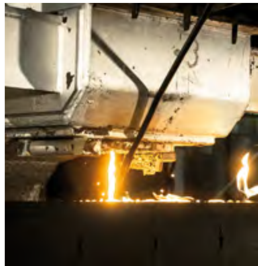
Gießen: Das Gusseisen wird in eine individuelle Sandform gegossen, die nach Gebrauch zerstört wird.
