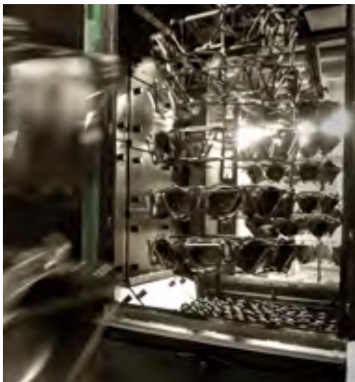
Kugelstrahlen als Vorbereitung für die Emaillierung
